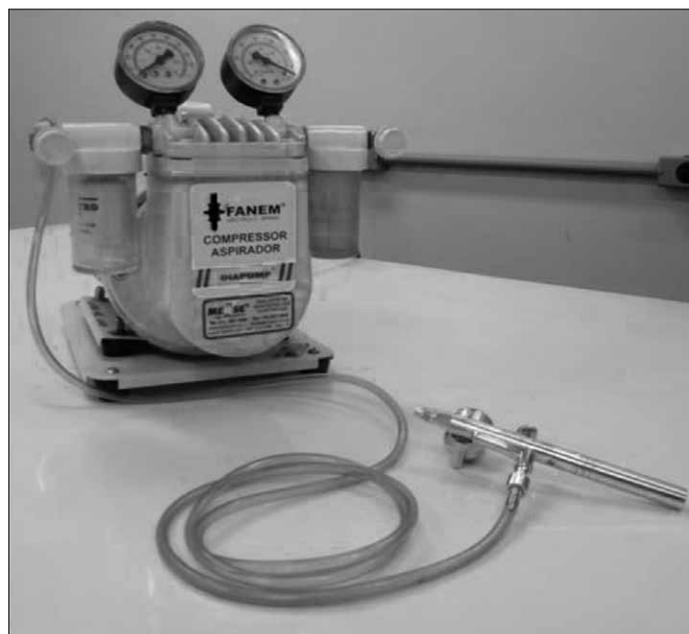
Figura 1. Aparelho aerógrafo acoplado a um compressor de fluxo contínuo de ar utilizado na aplicação dos produtos agroecológicos em folhas de mandioca.
