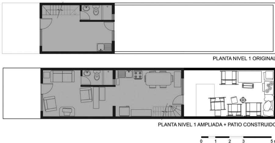
Figura 3. Planimetría Caso 07. Nivel 1: Planta original y planta ampliada con patio urbano construido.
